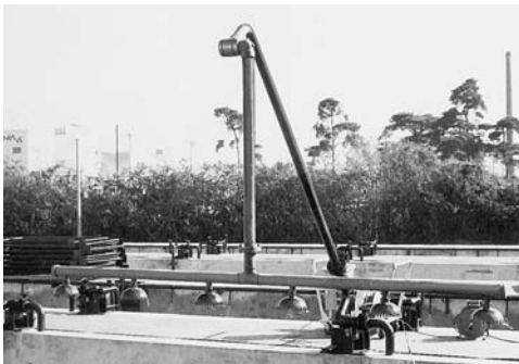
曝気槽用、スイングデフューザー Swing Diffuser for Use in Aeration Facility 口径・・・80A Caliber 流体・・・空気 Fluids: Air 圧力・・・0.5kgf/cm 2 G Pressure 温度・・・60℃ Temperature:
